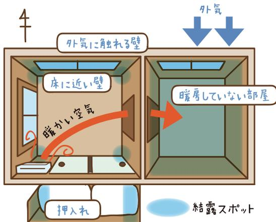
外気に触れるサッシまわりは結露スポット。外気と接する壁や、暖かい空気が流れ込む場所も要注意。
